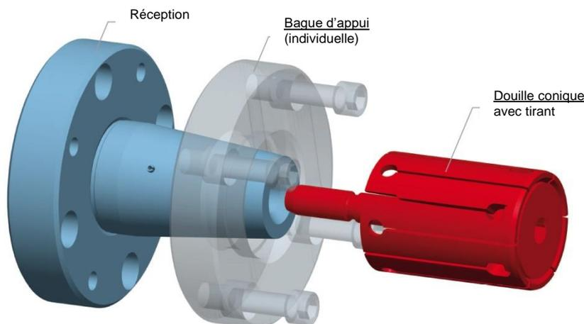
Le mandrin à douille expansible BKDF se compose de la réception et de la douille conique avec tirant. On dispose en option de douilles coniques avec six pans extérieurs (type de construction BAD), avec un centrage préalable (type de construction BVD), ou une plaque fileté pour le serrage manuel. Une bague d'appui est toujours construite individuellement pour la pièce à usiner. Le client fabrique généralement la bague d'appui lui-même.
