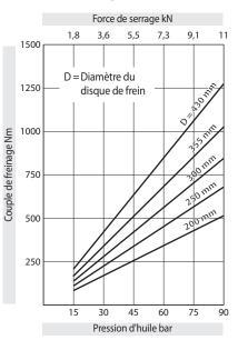
Les couples donnés dans ce tableau sont calculés avec un coefficient de friction théorique de 0,3.
