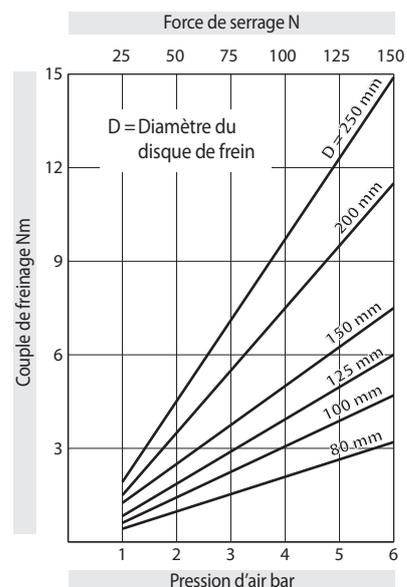
Les couples donnés dans ce tableau sont calculés avec un coefficient de friction théorique de 0,4.
