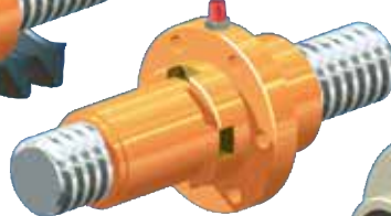
Duplexmutter DM - beidseitige Befestigungsmöglichkeit für Faltenbalg - gleicher Ø am Getriebegehäus, Mutter und Gegenlagerplatte - Schmiernippel bzw. Anschluss an Zentralschmierung oder Schmierstoffgeber
