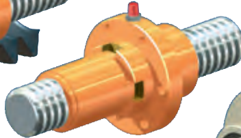
Écrou Duplex DM - Possibilité de fixation des deux côtés pour le soufflet - Même Ø à l'épaulement vérin, à l'écrou et au palier - Graisseur, ou raccord à la lubrification centrale ou au lubrificateur automatique
