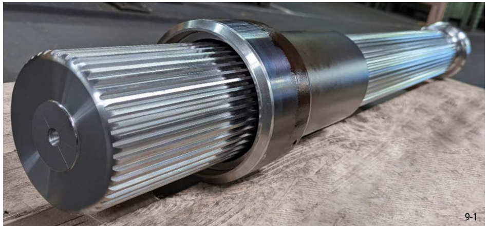
Wälzgefräster Zahnwellenzapfen mit Zahnabenhülse in extra langer Ausführung.
