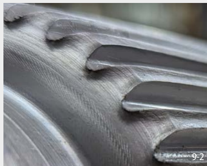
Detail-Aufnahme eines kaltgewalzten Zahnwellenzapfens
