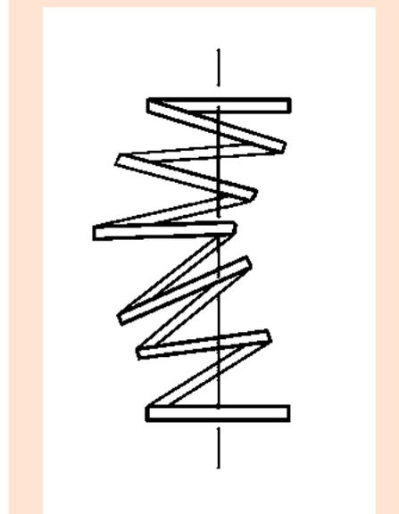
Unerwünschtes seitliches Ausknicken von eingängigen Druckfedern
