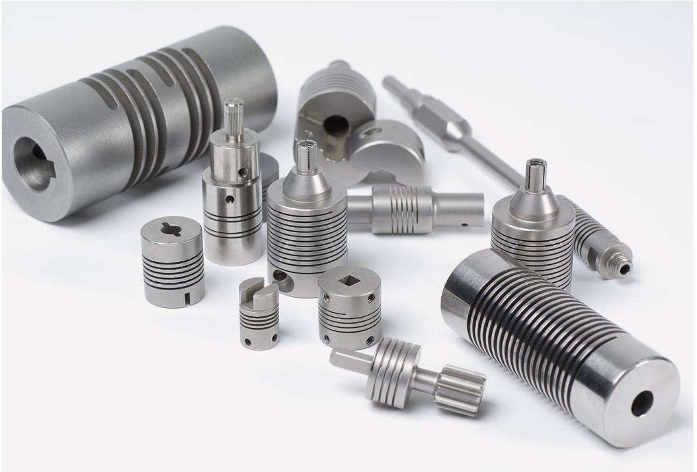
HELI-CAL®-Flexures bzw. -Kupplungen sind **aus einem Stück gefertigte Wellenkupplungen**, die aus homogenen Werkstoffen hergestellt werden. Sie bestehen in ihrer Grundform aus einem zylindrischen Körper, in dem eine helixförmige verlaufende Nut (Flexure) eingearbeitet ist. Diese schraubenartige Form erlaubt eine genaue Flexzone, aus der sich eine exakt berechenbare Elastizität ergibt.
