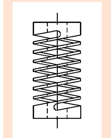
Kein unerwünschtes seitliches Ausknicken mit einer zwei- oder mehrgängigen Machined Spring
