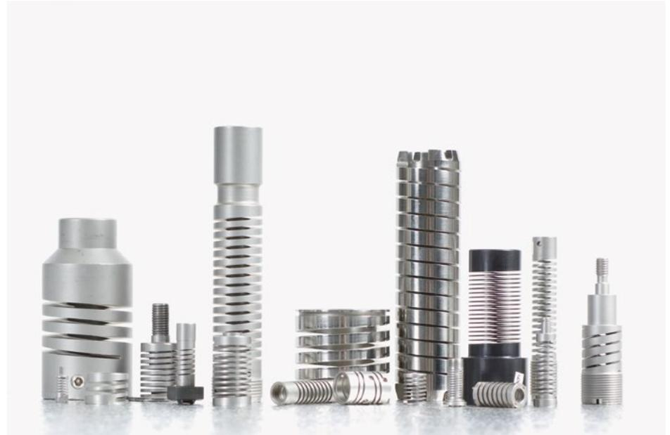
einem Rohr. Darin wird eine wendelförmige Nut geschnitten. Dieses Bearbeitungsverfahren eignet sich besser als das Wickeln einer Feder, denn es erzeugt im Gegensatz zum Umformen keine interne «künstliche» Spannung, sondern nur die natürliche Materialspannung. Die Feder erhält dadurch eine lineare Federkennlinie mit hoher Wiederholgenauigkeit und Dauerfestigkeit.
