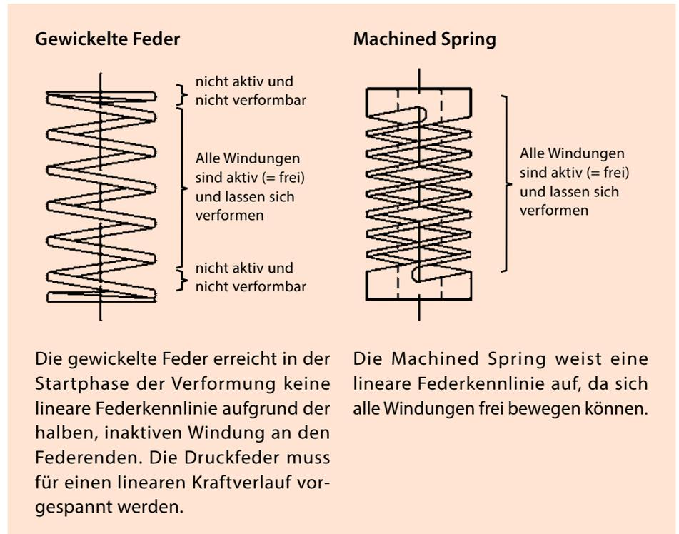
Bild 9: Auswirkung des Feder-Prinzips auf die Kennlinie
